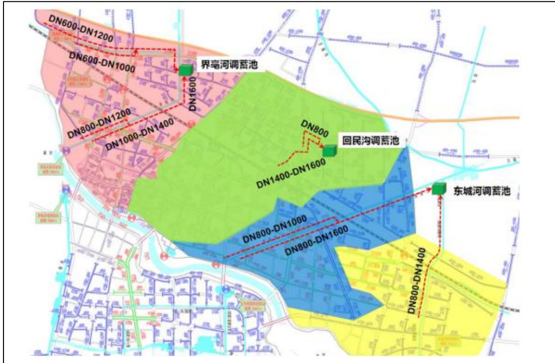
图 3-3 调蓄池收水范围图及截流管道布置图
